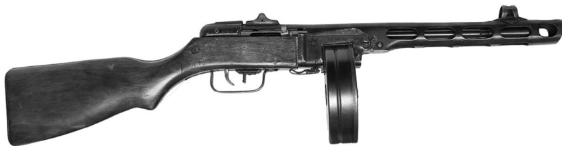
7,62-мм пистолет-пулемет образца 1941 года системы Шпагина (ППШ) 25
